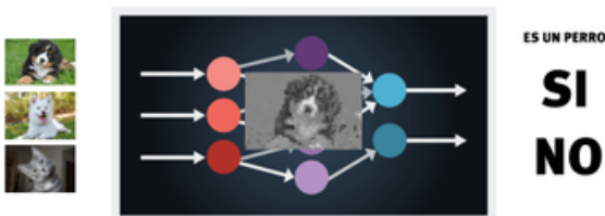
Funcionamiento de una red neuronal para la clasificación de perros
